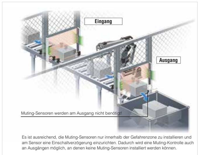
Es ist ausreichend, die Muting-Sensoren nur innerhalb der Gefahrenzone zu installieren und am Sensor eine Einschaltverzögerung einzurichten. Dadurch wird eine Muting-Kontrolle auch an Ausgängen möglich, an denen keine Muting-Sensoren installiert werden können.
