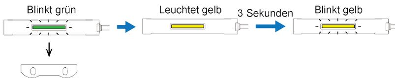
5. Lassen Sie den **SG-P20-M** innerhalb von sechs Sekunden nach dem Übergang in den Einlernmodus denselben Aktor erkennen. Wenn der Aktor erkannt wird, leuchtet die Anzeige grün. Nachdem der Erkennungsstatus drei Sekunden lang beibehalten wurde, blinkt die Anzeige grün.
