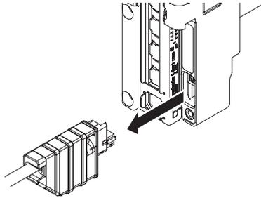
Schritt 3: Trennen Sie das USB-Kabel von Gerät oder PC.
