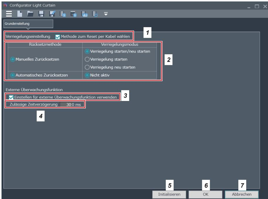
1. Markieren Sie dieses Kontrollkästchen, um die Verriegelungseinstellungen über das Lichtgitterkabel zu konfigurieren. Um die Einstellungen über die Software zu konfigurieren, entfernen Sie die Markierung.
