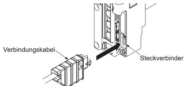
Schritt 3: Schließen Sie das Gerät mit einem USB-2.0-Kabel an einen PC an (A – Mini-B, separat erhältlich).
