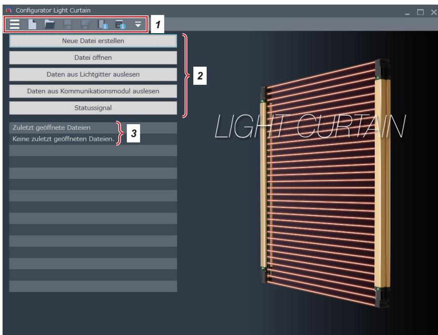
1. Symbolleiste. Mit dem links angezeigten „☰“ können Sie alle Funktionen des Software-Tools anzeigen und auswählen.
