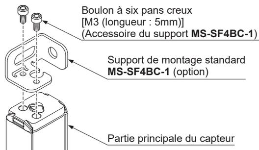
Étape 2 Fixez le support de montage standard à la surface de montage à l'aide de boulons à six pans creux [M5 (acheter séparément)].
