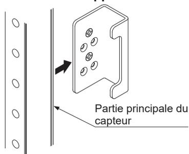
Nota: **SF4B-H□C□**: 48 canaux de faisceaux min., **SF4B-A□C□**: 24 canaux de faisceaux min. nécessitent l'utilisation de l'étrier de support intermédiaire à utiliser avec le support de montage standard **MS-SF4BC-5** (option).
