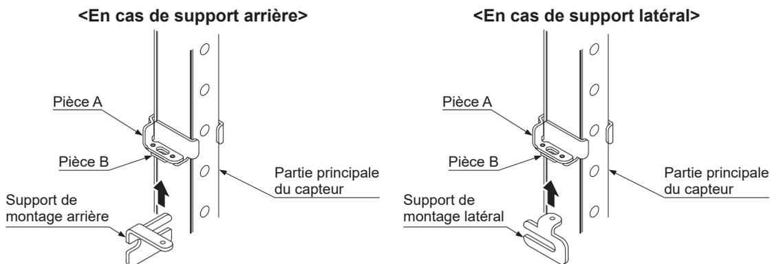
Étape 5 Fixez la pièce A, la pièce B et le support de montage arrière ou latéral avec un boulon à six pans creux [M3 (longueur : 6mm)]. Le couple de serrage doit être de 0,5 N·m.
