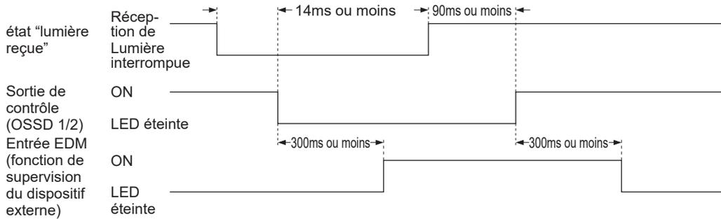
Le temps de réponse du dispositif de surveillance externe est de 300ms maxi. S'il dépasse 300ms l'appareil se met en état de verrouillage. Il peut être réglé sur une valeur comprise entre 100 et 600ms (unité : 10ms) en utilisant le contrôleur portable (**SFB-HC**) (en option)
