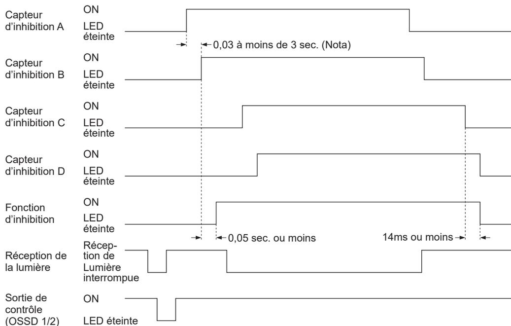
Nota : Si la différence de temps d'entrée admissible entre les capteurs d'inhibition A et B est d'environ  $0,03$  seconde, le temps d'entrée fluctue à cause des effets de la configuration périphérique d'entrée / circuit et cela peut désactiver l'utilisation de la fonction d'inhibition.
