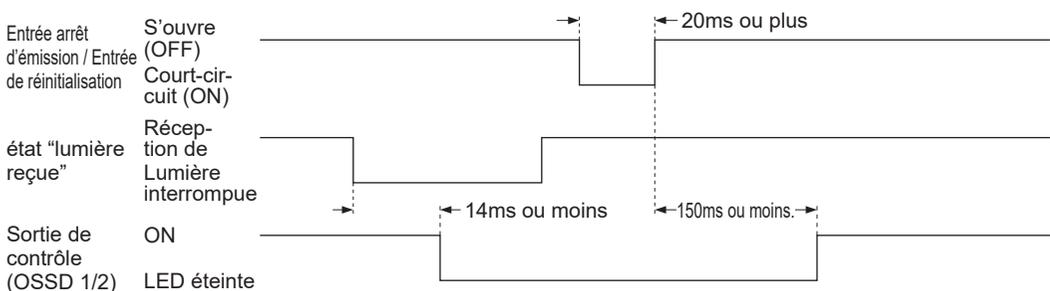
**Réinitialisation automatique :** La sortie de contrôle (OSSD 1/2) n'est pas mise sur ON automatiquement lorsque l'appareil reçoit de la lumière.
