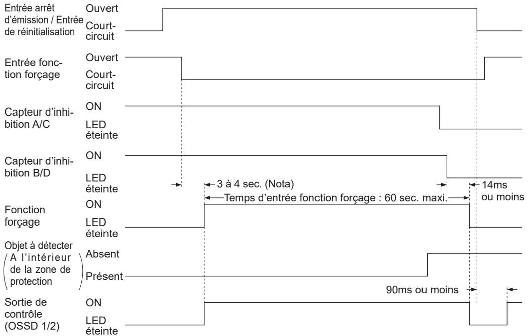
Nota : C'est lorsque la fonction diagnostic de la indicateur d'inhibition est valide. Si le témoin d'inhibition ne s'allume pas même si 1 sec. s'est écoulée, la fonction de substitution devient invalide. Lorsque la fonction de diagnostic du témoin d'inhibition n'est pas valide, la fonction d'inhibition devient valide 3 secondes après que les conditions d'entrée du capteur d'inhibition A (C) et B (D) aient été satisfaites.
