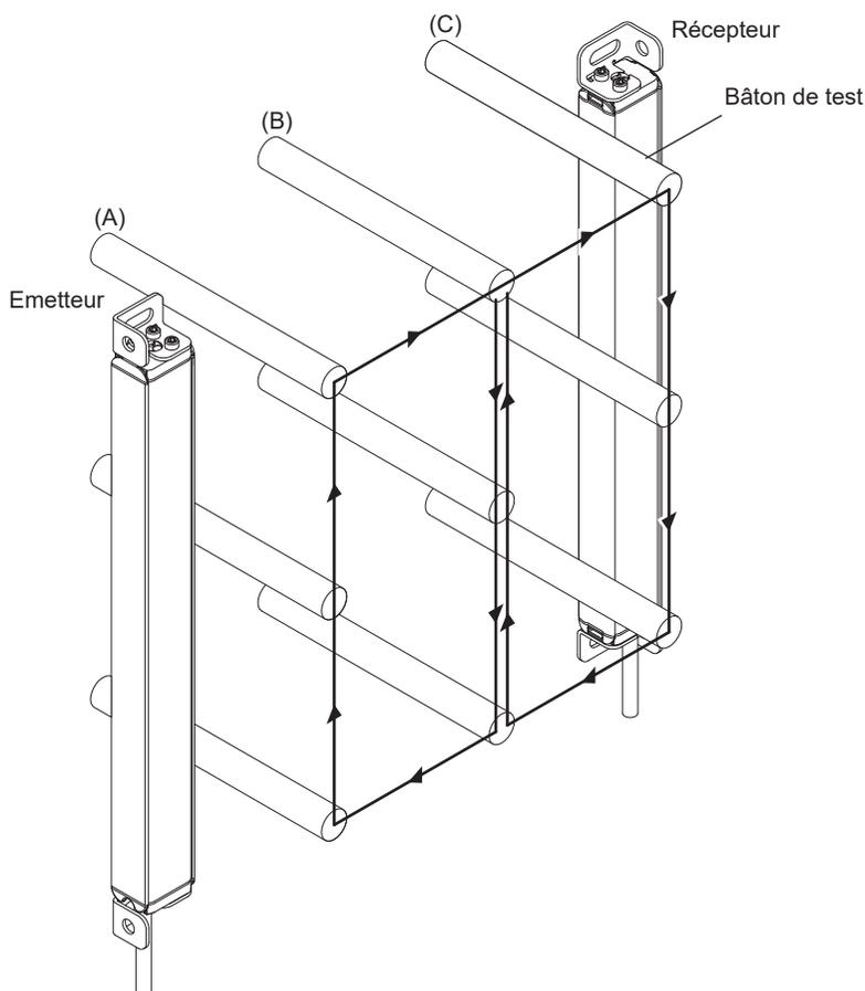
Etape 4 Pendant l'Etape 3au-dessus, vérifiez que les sorties de contrôle (OSSD 1/2), soient en position OFF toutes les deux, et que l'indicateur OSSD (rouge) du récepteur ainsi que l'indicateur de fonctionnement (rouge) de l'émetteur sont allumés tant que la tige de test est dans la zone de détection.
