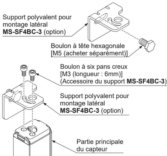
Étape 2 Fixez le support polyvalent pour montage latéral à la surface de montage à l'aide de boulons à six pans creux [M5 (acheter séparément)].
