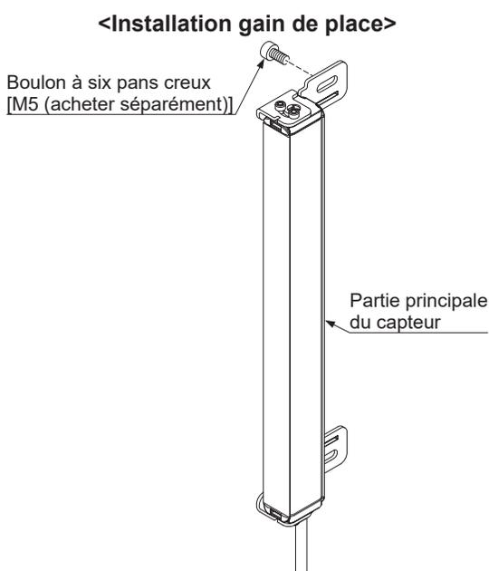
Notas: 1) Utilisez des rondelles M5 (accessoires du support **MS-SF4BC-6**) en cas de fixation à un cadre en aluminium.
