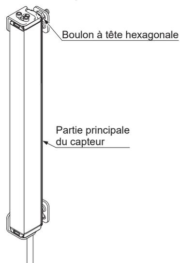
Nota: Utilisez des rondelles M5 (accessoires du support MS-SF4BC-2) en cas de fixation à un cadre en aluminium.
