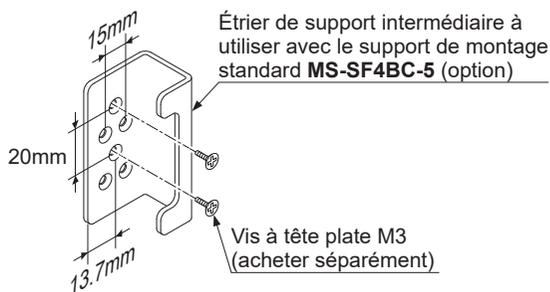
Étape 2 Insérez le dispositif dans l'étrier de support intermédiaire.
