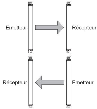
3) Installer l'émetteur et le récepteur horizontalement dans le sens opposé.
