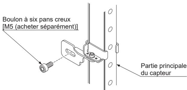
Nota: **SF4B-H□C□**: 48 canaux de faisceaux min., **SF4B-A□C□**: 24 canaux de faisceaux min. nécessitent l'utilisation de l'étrier de support intermédiaire à utiliser avec le support polyvalent **MS-SF4BC-7** (option).
