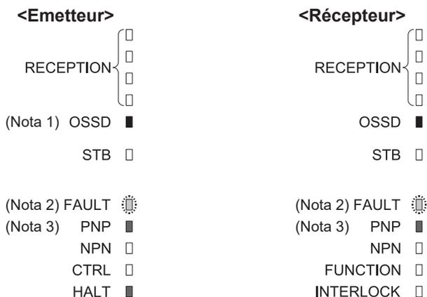
Nota : 1) La couleur de l'indicateur de fonctionnement variant en fonction de l'état ON/OFF de la sortie de contrôle (OSSD 1/2), l'indicateur de fonctionnement est désigné sur la barrière immatérielle de sécurité par « OSSD ».
