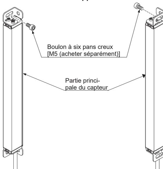
Nota: Utilisez des rondelles M5 (accessoires du support **MS-SF4BC-1**) en cas de fixation à un cadre en aluminium.
