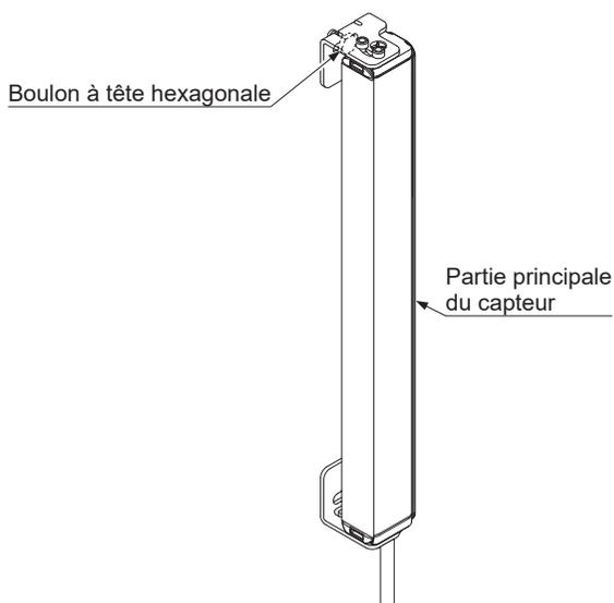
Nota: Utilisez des rondelles M5 (accessoires du support MS-SF4BC-3) en cas de fixation à un cadre en aluminium.
