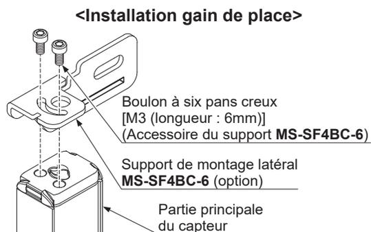
Étape 2 Fixez le support de montage latéral à la surface de montage à l'aide de boulons à six pans creux [M5 (acheter séparément)].
