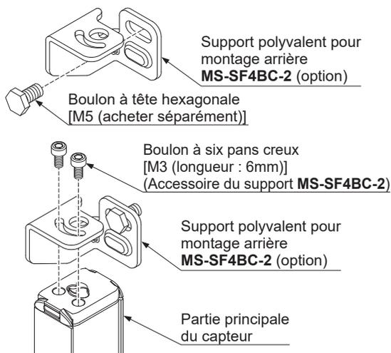
Étape 2 Fixez le support polyvalent pour montage arrière à la surface de montage à l'aide de boulons à six pans creux [M5 (acheter séparément)].
