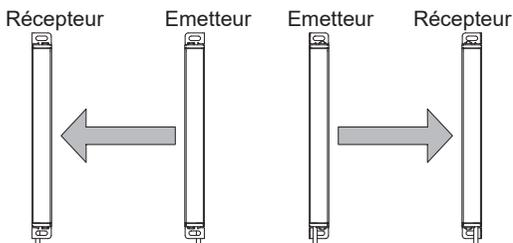
2) Installer l'émetteur et le récepteur verticalement dans le sens opposé.
