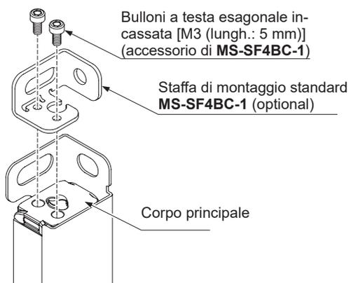
Fase 3 Allineare il foro di montaggio della custodia metallica protettiva a quello della staffa di montaggio standard e installare sulla superficie di montaggio utilizzando bullone a testa esagonale incassata [M5 (da acquistare a parte)].
