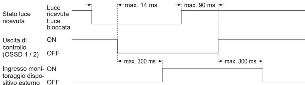
Il tempo di impostazione del monitoraggio del dispositivo è di max. 300 ms. Il superamento dei 300 ms porta il dispositivo in stato di blocco. L'intervallo di impostazione è compreso tra 100 e 600 ms (unità: 10 ms) utilizzando il controller manuale SFB-HC) (optional).
