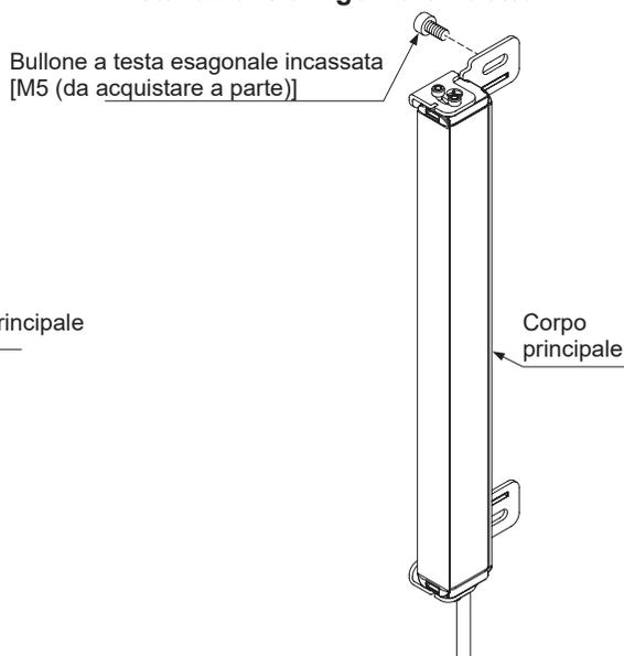
Note: 1) Utilizzare rondelle M5 (accessorio di **MS-SF4BC-6**) in caso di montaggio su un telaio di alluminio.
