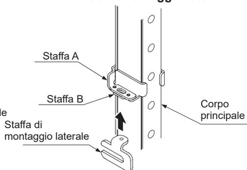
Fase 5 Fissare in posizione la staffa A, la staffa B e la staffa di montaggio sul retro/laterale con un bullone a testa esagonale incassata [M3 (lunghezza: 6 mm)].
