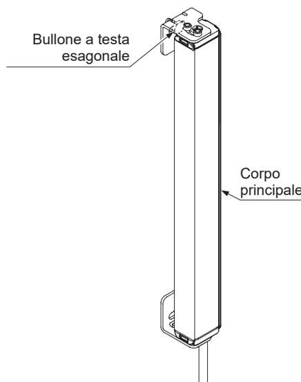
Nota: Utilizzare rondelle M5 (accessorio di **MS-SF4BC-3**) in caso di montaggio su un telaio di alluminio.
