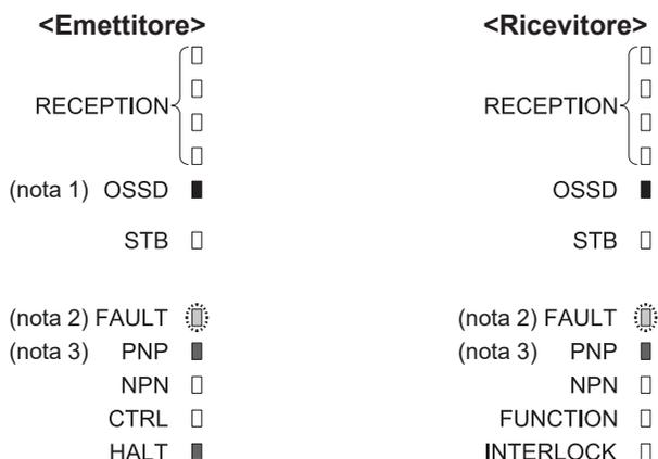
Note: 1) Poiché il colore dell'indicatore di funzionamento cambia in base allo stato ON/OFF dell'uscita di controllo (OSSD 1 / 2), l'indicatore di funzionamento sul dispositivo è contrassegnato come "OSSD".
