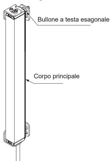
Nota: Utilizzare rondelle M5 (accessorio di **MS-SF4BC-2**) in caso di montaggio su un telaio di alluminio.
