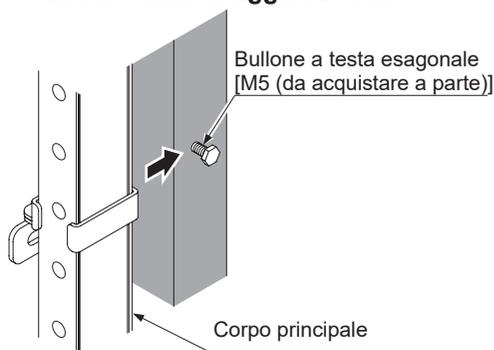
Nota: **SF4B-H□C□**: 48 fasci luminosi o più, **SF4B-A□C□**: 24 fasci luminosi o più richiedono l'utilizzo di una staffa intermedia di supporto abbinata alla staffa di montaggio **MS-SF4BC-4** (optional).
