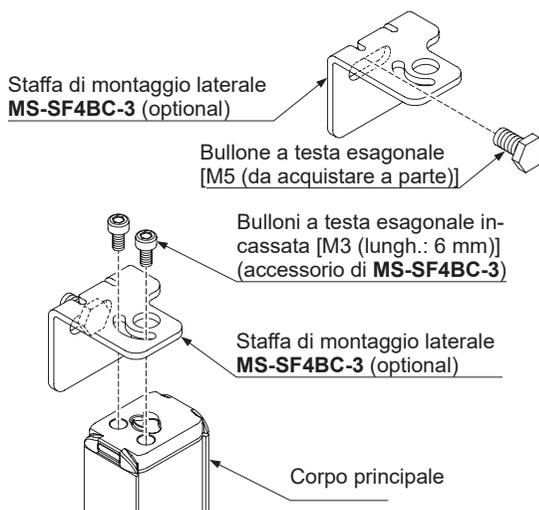
Fase 2 Installare la staffa di montaggio laterale sulla superficie utilizzando bulloni a testa esagonale incassata [M5 (da acquistare a parte)].
