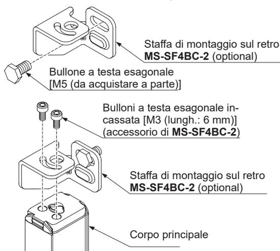
Fase 2 Installare la staffa di montaggio sul retro sulla superficie utilizzando bulloni a testa esagonale incassata [M5 (da acquistare a parte)].
