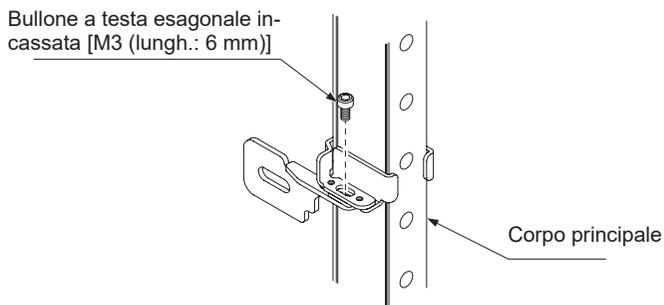
Fase 6 Installare la staffa intermedia di supporto per la staffa di montaggio laterale sulla superficie utilizzando bulloni a testa esagonale incassata [M5 (da acquistare a parte)].
