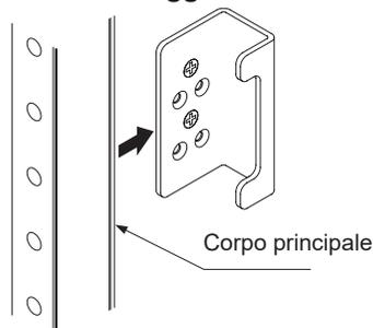
Nota: **SF4B-H□C□**: 48 fasci luminosi o più, **SF4B-A□C□**: 24 fasci luminosi o più richiedono l'utilizzo di una staffa intermedia di supporto abbinata alla staffa di montaggio standard MS-SF4BC-5 (optional).
