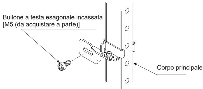
Nota: **SF4B-H□C□**: 48 fasci luminosi o più, **SF4B-A□C□**: 24 fasci luminosi o più richiedono l'utilizzo di una staffa intermedia di supporto abbinata alla staffa di montaggio laterale **MS-SF4BC-7** (optional).
