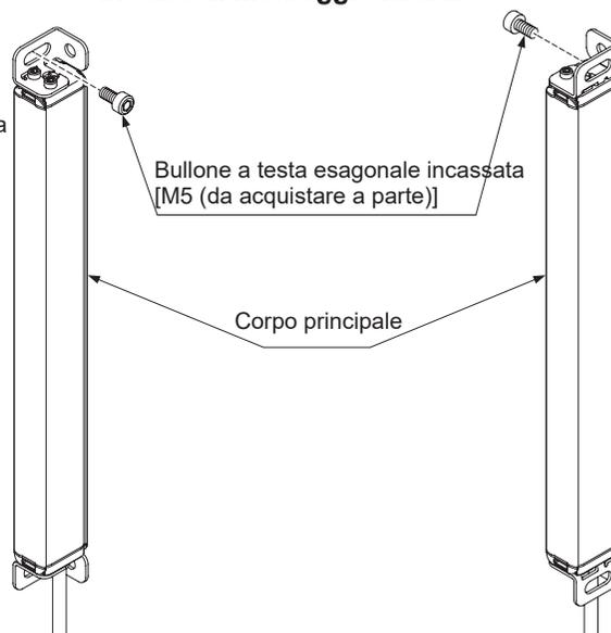
Nota: Utilizzare rondelle M5 (accessorio di MS-SF4BC-1) in caso di montaggio su un telaio di alluminio.
