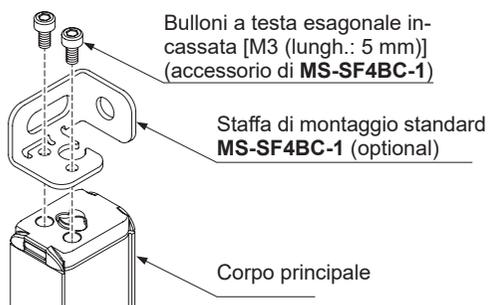
Fase 2 Montare la staffa standard sulla superficie di montaggio utilizzando bulloni a testa esagonale incassata [M5 (da acquistare a parte)].
