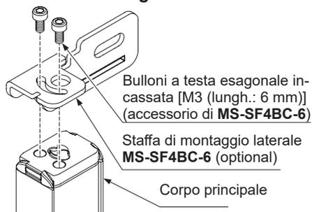
Fase 2 Installare la staffa di montaggio laterale sulla superficie utilizzando bulloni a testa esagonale incassata [M5 (da acquistare a parte)].
