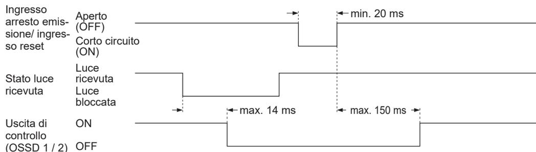
Reset automatico: L'uscita di controllo (OSSD 1 / 2) si porta automaticamente su ON quando il dispositivo riceve luce.
