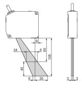
8 BEAM DIAMETER (Unit: mm)
