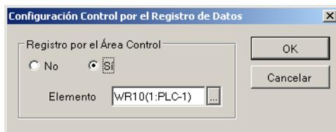
Se pueden controlar ciertas funciones de recopilación de datos desde un PLC activando el Registro por el Área Control y especificando la dirección inicial en el elemento de control. A continuación se describen las área de control.
