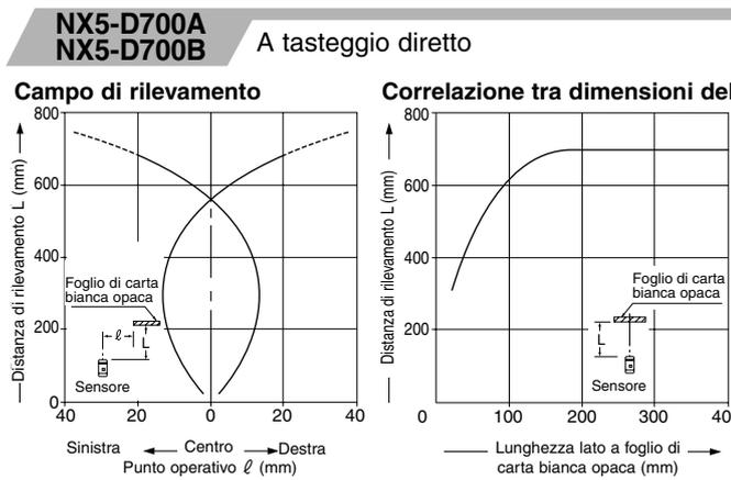
Se l'oggetto rilevato è inferiore alle dimensioni standard (foglio di carta bianca opaca 200 × 200 mm), il campo di rilevamento diminuisce.
