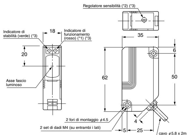
(\*1) Sull'emettitore del modello **NX5-M30□** è sostituito dall'indicatore di alimentazione.
