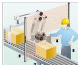
**Blanking fisso** - L'handy controller permette di impostare la funzione di blanking fisso la quale previene che l'uscita di controllo (OSSD) si disattivi anche se alcuni fasci sono stati interrotti. Questa funzionalità è utile in applicazioni dove una qualsiasi ostruzione interrompe alcuni fasci.
