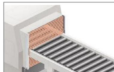
**Blanking flottante** - Funzione di blanking flottante permette ai singoli fasci ottici di essere disattivati migliorando la produttività.
