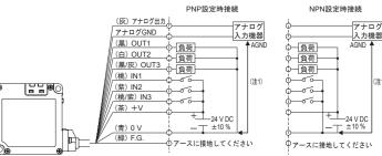
(注1): 本体用電源 (0 V) とアナログ出力のAGNDは、**HL-G2**内部で接続されています。外部機器と電 位差が生じないようにしてください。接続機器や本製品の故障・誤動作の原因となります
