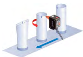
RILEVA LE TACCHE STAMPATE PER ALLINEARE I TUBI
