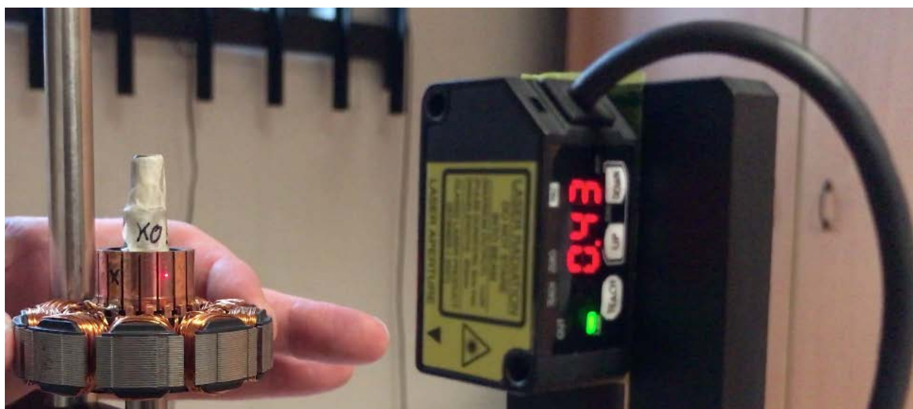
CONTROLLO FESSURE SU AVVOLGIMENTO ELETTRICO
