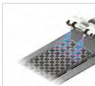
Neutralización de cargas electrostáticas al recoger los chips de la cinta
