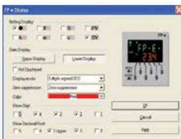
FPWIN Pro offre finestre di dialogo facili da usare per una configurazione efficiente del PLC. Ad esempio per il PLC FPE è possibile controllare in anteprima le impostazioni nel display all'interno della finestra di dialogo.
