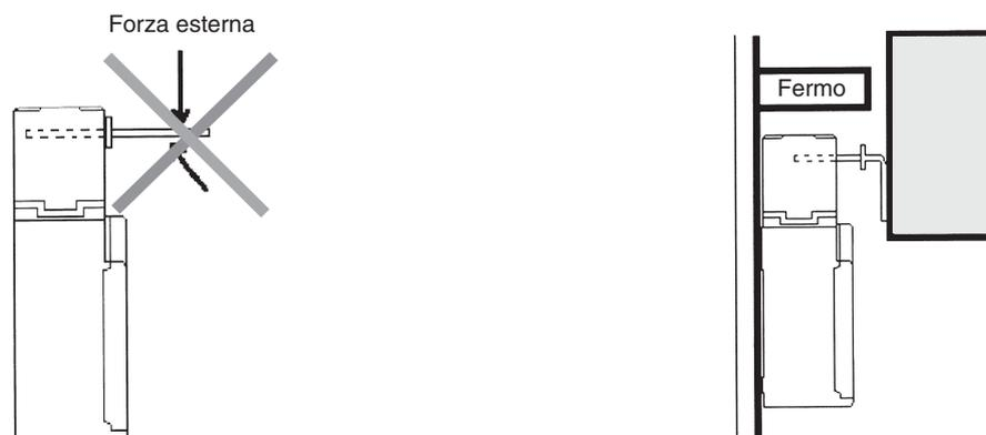
Dopo aver installato il finecorsa assicurarsi che la chiave sia perfettamente in piano con l'ingresso del finecorsa e non abbia inclinazioni particolari.
