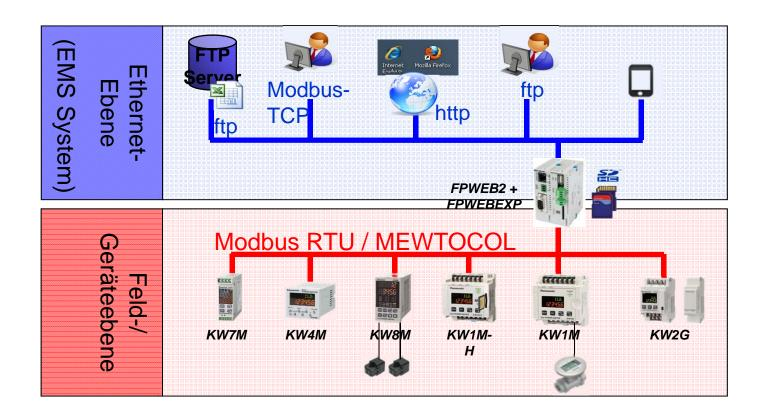
Messwerte müssen vom Gerät aus der Feldebene zum EMS System in die Ethernetebene übermittelt werden!
