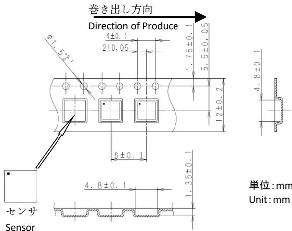
図2 キャリアテープサイズ Figure 2 Carrier tape Size
